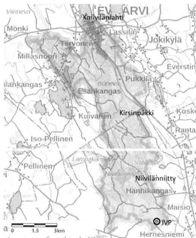
Kuva 3. Kirsinpäkin valuma-alue laskussa Kniivilänlahteen on 49,05 km 2 . Valuma-alue on metsämaata ja ojitettuja suoalueita ja peltoalueita uoman alaosalla. JVP on Lappajärven jätevedenpuhdistamo, jonka vedet laskevat Kirsinpäkkiin ( http://paikkatieto.ymparisto.fi/value/ ).
